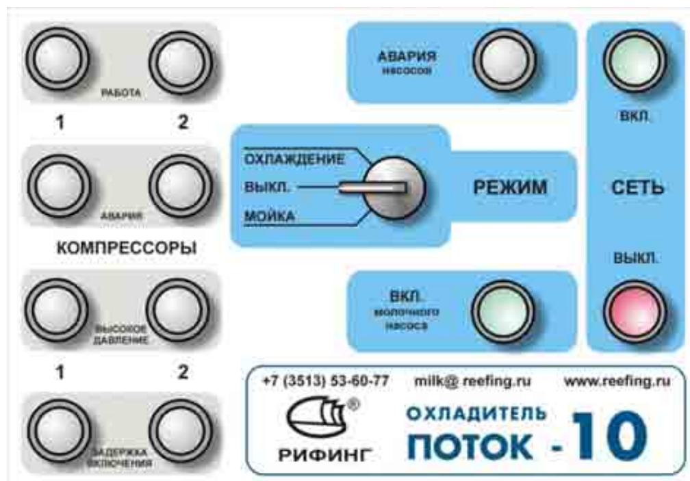
Рисунок 2 – Внешний вид панели управления охладителей ПОТОК-8, ПОТОК-10, ПОТОК-12.
