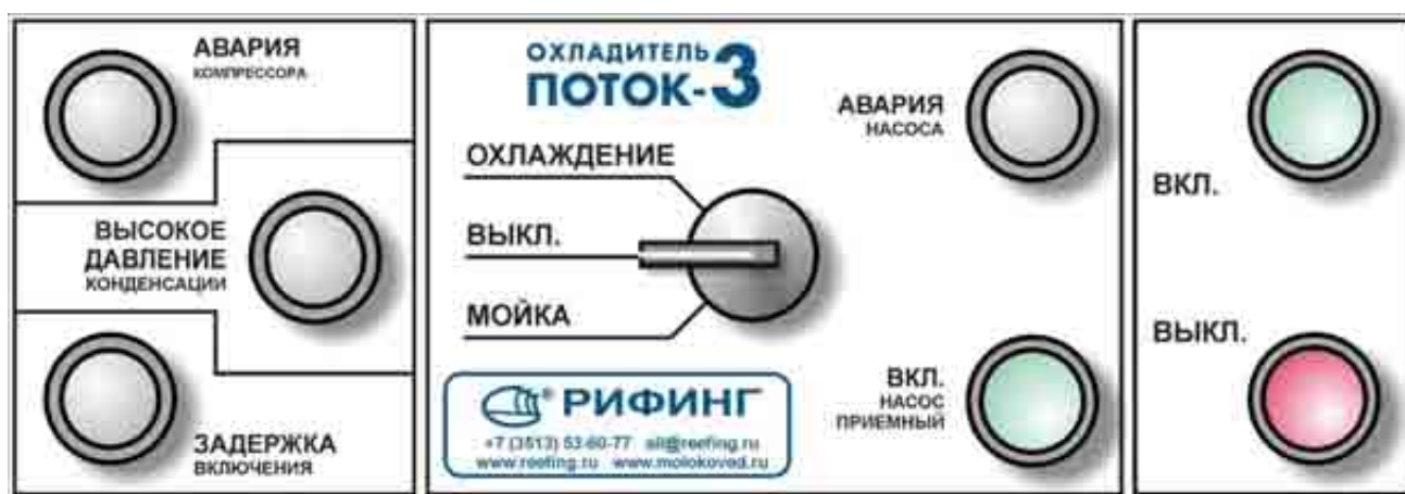
Рисунок 2 – Внешний вид панели управления охладителей ПОТОК-1, ПОТОК-2, ПОТОК-3, ПОТОК-4, ПОТОК-5, ПОТОК-6
