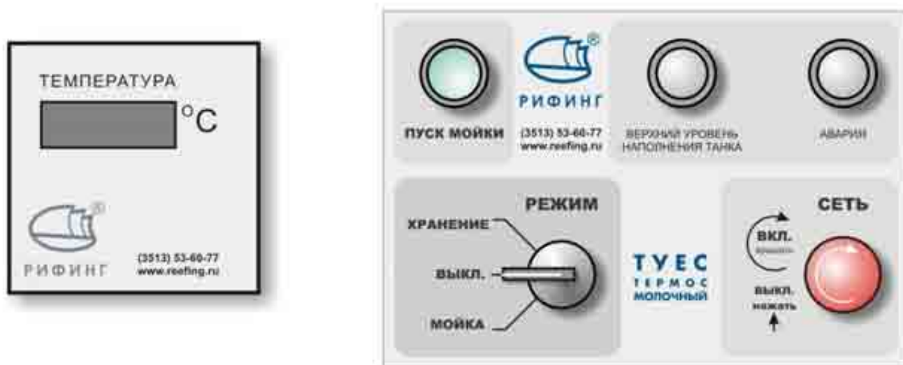
Рисунок 3 – Внешний вид панели управления автомата промывки
