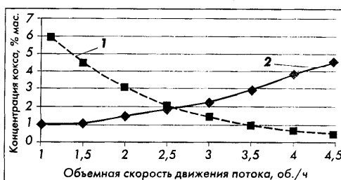
Рис. 3. Зависимость концентрации кокса на поверхности катализатора в зависимости от объемной скорости движения потока в различных направлениях: 1 — прямое (от периферии к центру); 2 — обратное
